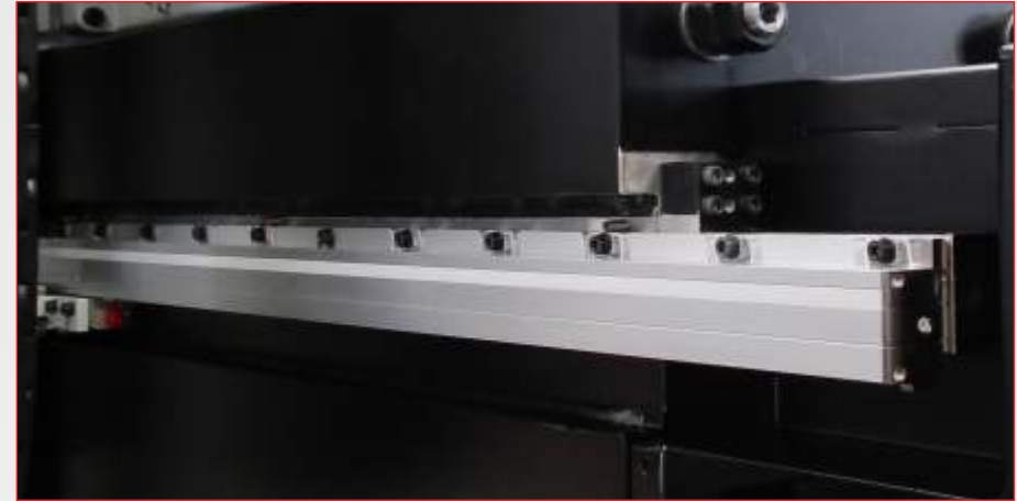
Trasduttore ottico di posizionamento - Optical positioning transducer Optischer Wegaufnehmer - Transducteur de positionnement optique.
