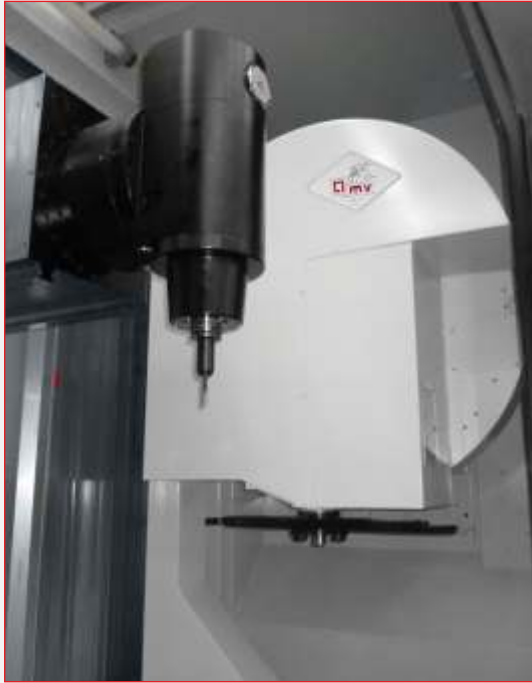
Magazzino a ruota con braccio di scambio posizionato lateralmente.
