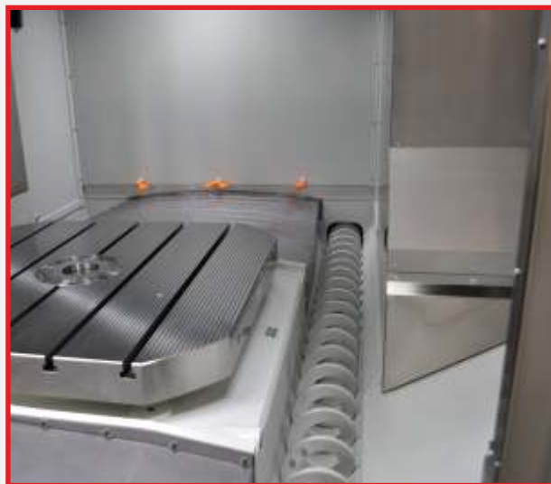
Sistema di evacuazione truciolo e lavaggio. Chip scavenging and washing system. Spanabfuhr- und Waschsystem. Système d'évacuation et de lavage des copeaux.
